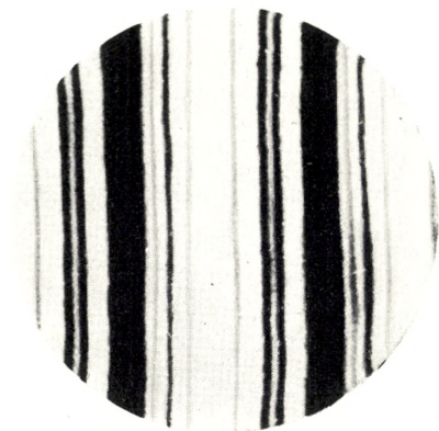
Fig. 4. Hyperfine structure of Hg 5461. 5 mm. wedge étalon.
