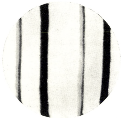
Fig. 5. Hyperfine structure of Tl 5351. 5 mm. wedge étalon.
